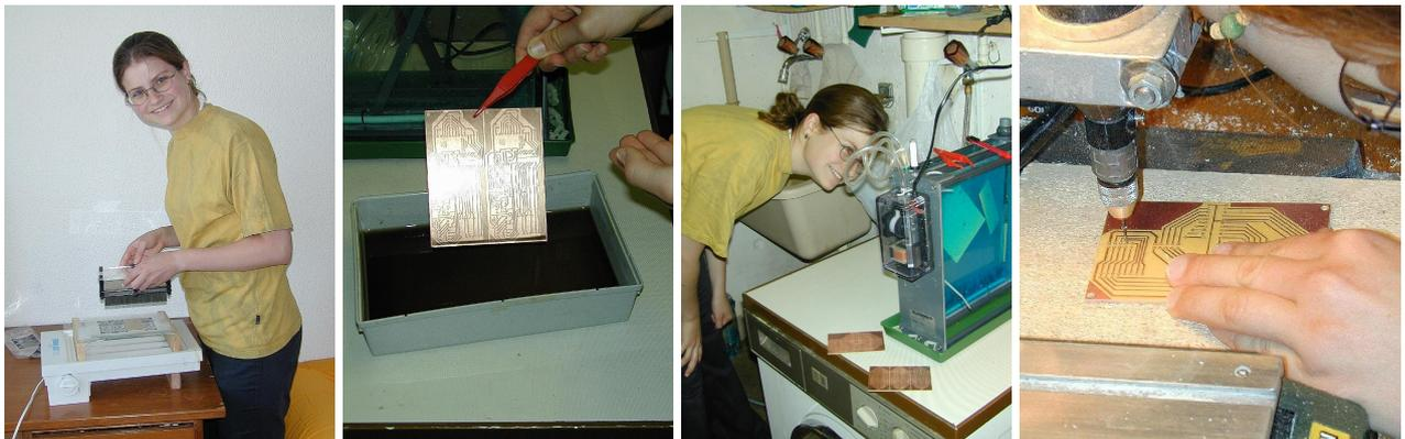
**Abbildung 3:** Herstellung einer Kupferplatine: Belichten, entwickeln, ätzen, bohren (v.l.n.r)
