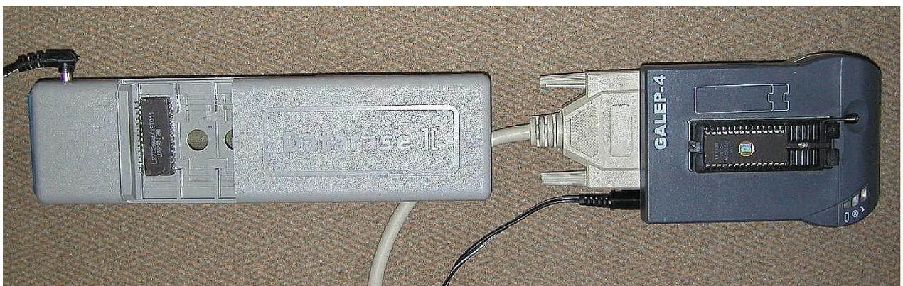
**Abbildung 4:** EPROM Löschergerät und Galep Programmiergerät
