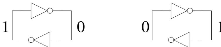
Abbildung 17: Grundschiung eines Flipflops aus zwei NOT-Gates
